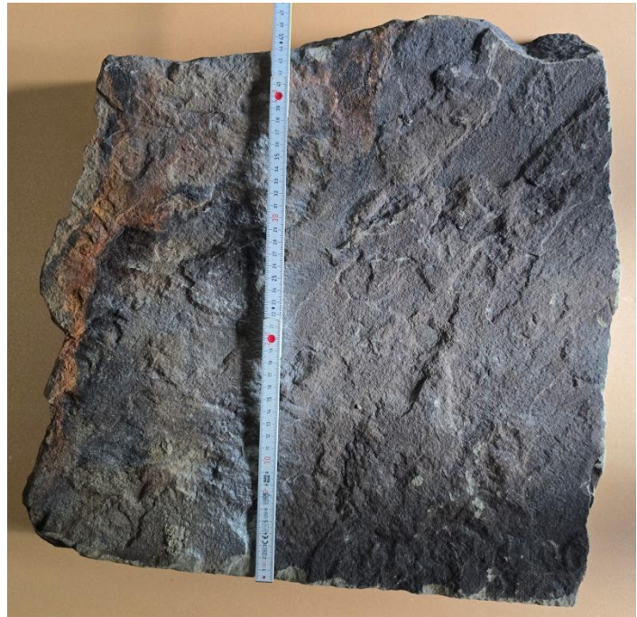
Masse der Sandsteinplatte= L. 50cm B. 50 cm D. 5,7 cm
