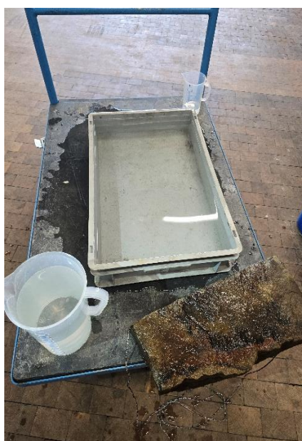
Spez. Gewicht mittels Wasserverdrängung
