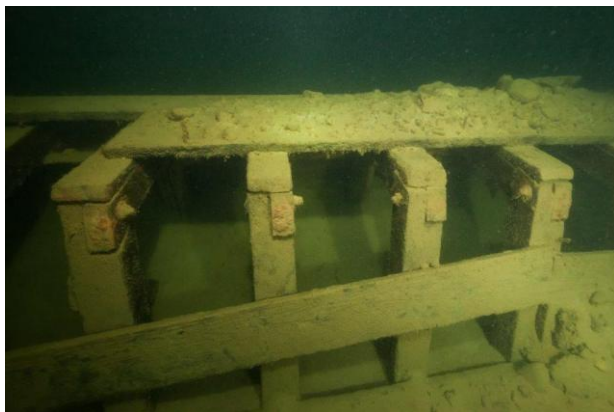
Laderaum ( Balken mit 4Kant Eisenschrauben zusammengeschräubt) Laderaum (Winkel 28°)
